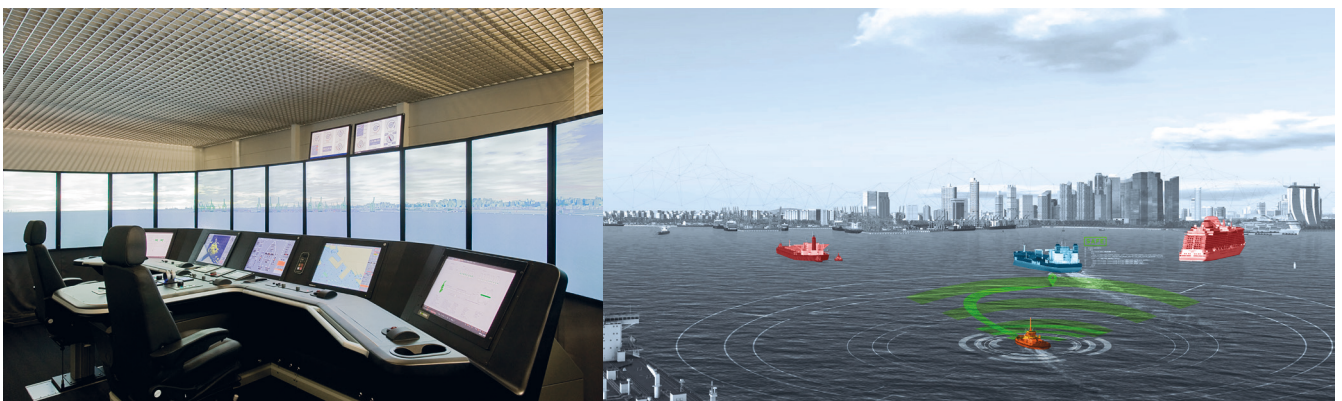
Abbildung 2: Die Schiffsbrücke und die mögliche Sicht des intelligenten Fensters in Augmented Reality, ©Wärtsilä
