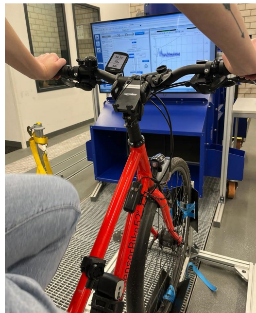
Abbildung 1: Biomechanische Analyse auf einem Rollenprüfstand mit dem „SensorBike“
