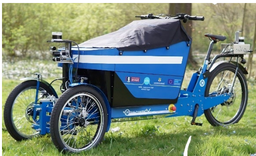
Abbildung 1: Sensorträgerplattform (Lastenrad) (Laghbani et al., 2025)
