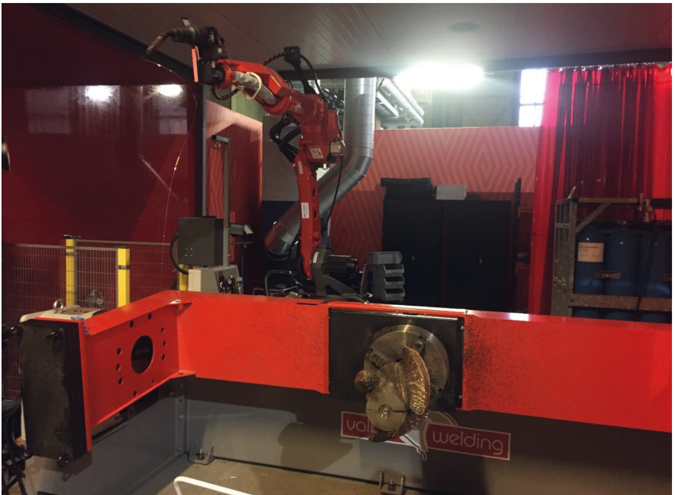
Abbildung 2: Druck eines Propellers mit dem WWAM-Verfahren
