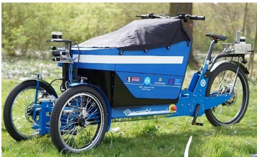
**Abbildung 1:** Sensorträgerplattform (Lastenrad) (Laghbani et al., 2025)
